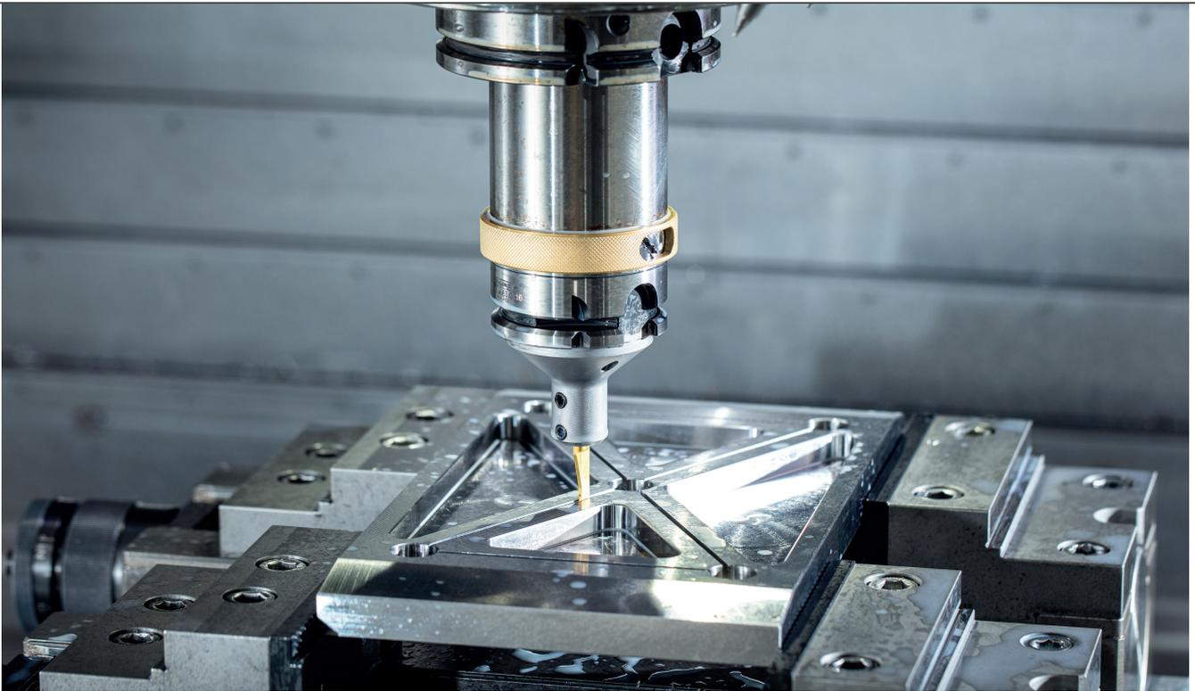
**Bei laufender Maschine mit viel KSS:** Beim Speed-Forming fährt die Schneide mit einer Hobelbewegung über das Werkstück.
